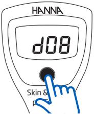
Desde el modo de medición, mantenga presionado el botón ON/OFF. La pantalla LCD mostrará "OFF", "CAL" seguido de "d08" (configuración predeterminada, 8 minutos). Suelte el botón ON/OFF. Una sola pulsación del botón ON/OFF cambiará el temporizador de apagado automático a "d60" (60 minutos). Para desactivar la función de apagado automático, presione el botón ON/OFF nuevamente, la pantalla LCD mostrará "d--". Mantenga presionado para salir.
